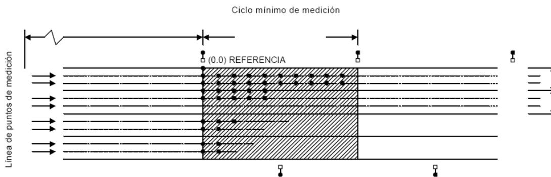
e) Nivel de Iluminación Promedio: deberá ser determinado mediante el valor promedio de todos los valores de los puntos de medición en las líneas de puntos del área cubierta por la medición de la calle, avenida u otro en evaluación.
